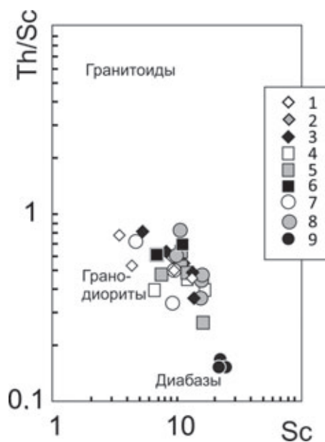
Рис. 9.5.8. Положение точек состава поверхностных донных отложений различных полигонов на диаграмме Sc–Th/Sc.
