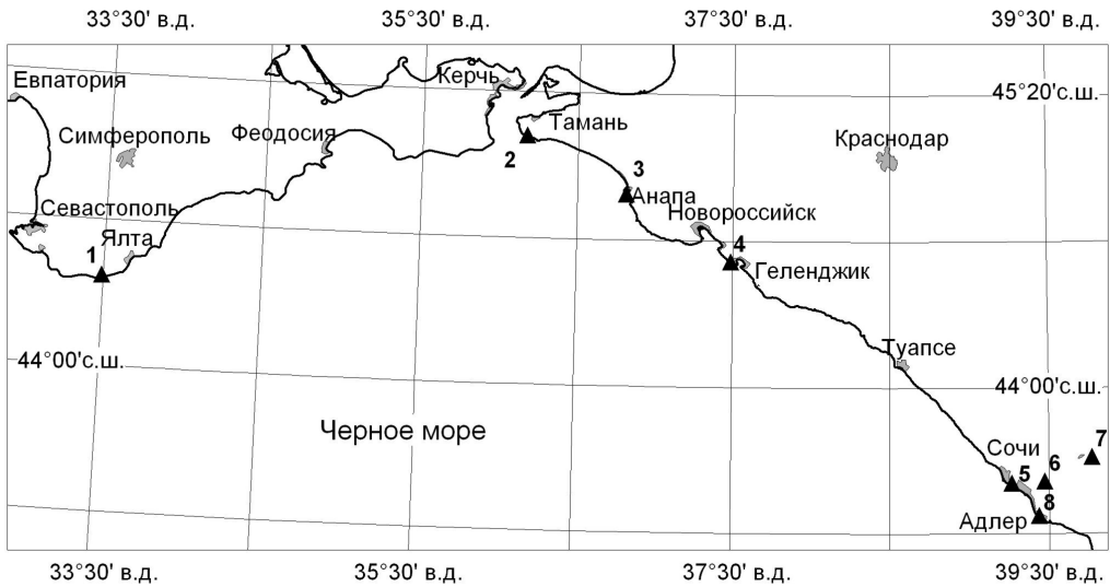
Рис. 1.3.1. Схема расположения спутниковых геодинамических пунктов на Российском сегменте побережья Черного моря.
